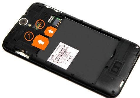
3. Установите батарею в штатный отсек, соединив позолоченные контакты телефона и батареи и нажав на нее до щелчка защелки.
