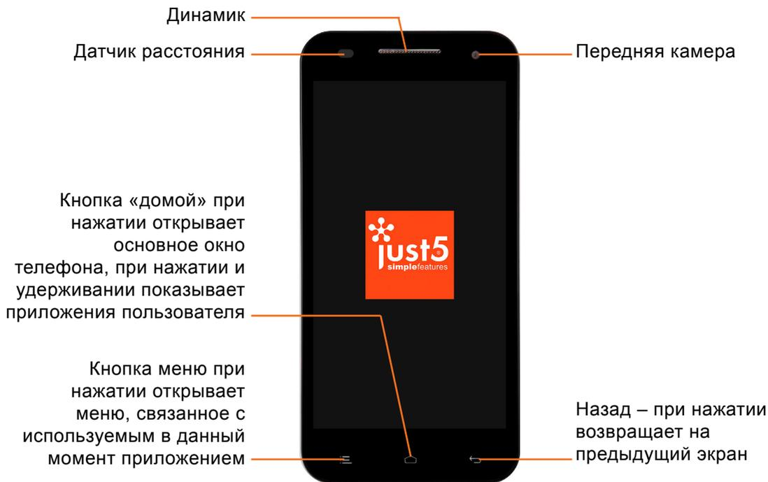
**ПРИМЕЧАНИЕ:** датчик расстояния. При приеме и совершении вызовов этот датчик автоматически отключает подсветку и блокирует сенсорный дисплей, регистрируя касания, когда телефон поднесен к уху. Это увеличивает срок службы батареи и препятствует непреднамеренной активации экрана во время разговора.
